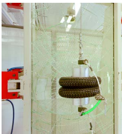
Provino intelaiato rotto
