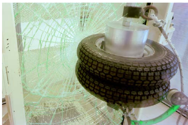
Provino intelaiato rotto:particolare
